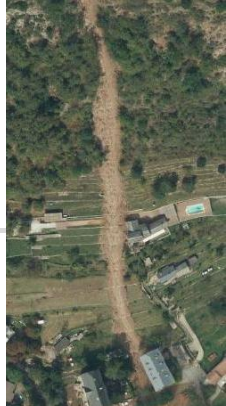
Illustration d'une coulée boueuse déclenchée par la tempête Alex (2020) dans les Alpes Maritimes. Effet d'atténuation des terrasses agricoles. Source : Géoportail © IGN
