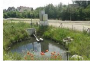
InSitu n°31 – Piégeage des polluants métalliques des eaux de ruissellement
