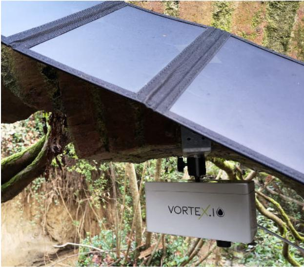
caméra permet un post-traitement intelligent des mesures afin de fournir des informations fiables pour la surveillance des systèmes hydrologiques et l'alerte lors des épisodes d'inondations ou de sécheresses.
